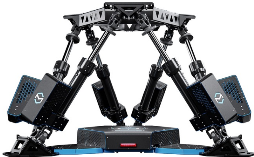
Il. 11. Platforma 6DOF, PS-6TL-1500, oparta na platformie Stewarta, źródło: https://motionsystems.pl/product/6dof-pl/ps-6tl-1500/ [dostęp: 27 kwietnia 2023]
